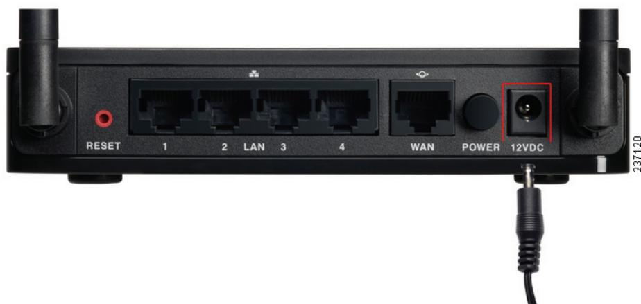
**PASSAGGIO 6** Collegare l'altra estremità dell'alimentatore a una presa di corrente. A seconda del paese potrebbe rendersi necessario l'utilizzo di una spina specifica (fornita).
