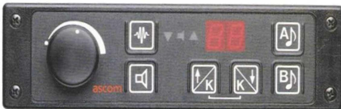
**Preparazione** : Collegare l'apparato a una sorgente in continua 12 V min 8A. Collegare l'altoparlante esterno 8 ohm ai morsetti previsti (fare riferimento al service manuale)
