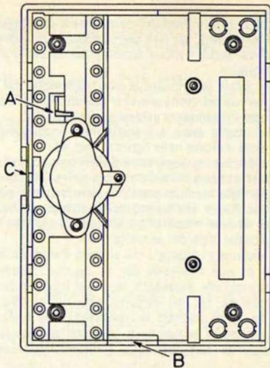
Ecco come si presenta il circuito stampato dopo essere stato staccato e ribaltato per una facile sostituzione di un qualsiasi eventuale componente avariato. Per rimontare detto circuito nella posizione primitiva fare attenzione che la linguetta A che sposta il commutatore di sensibilità, sia in posizione di riposo e cioè verso il centro dello strumento e che le insenature B e C si incastrino perfettamente nelle sporgenze B<sub>1</sub> e C<sub>1</sub>.
