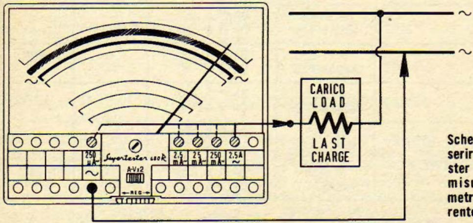
Schema come inserire il Supertester 680 R per le misure ampereometriche in corrente alternata.
