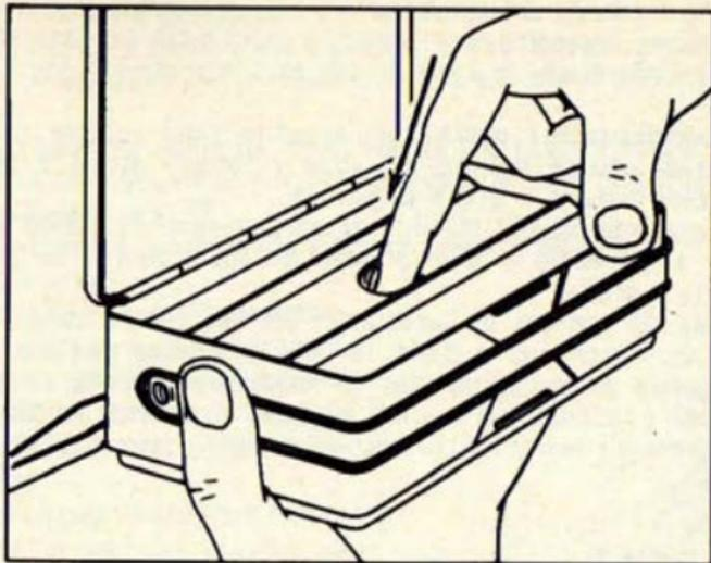
Aprire l'astuccio nella parte inferiore e con l'aiuto del dito indice spingere attraverso il foro centrale dell'astuccio stesso il Tester 680 R.
