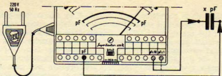
Schema come provare le capacità da 50 fino a 500 pF per mezzo della presa di rete in C.A.
