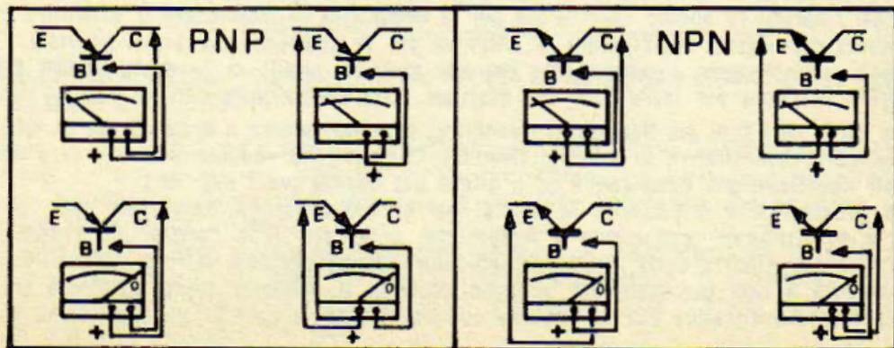
Posizione indice per la prova da transistors.
