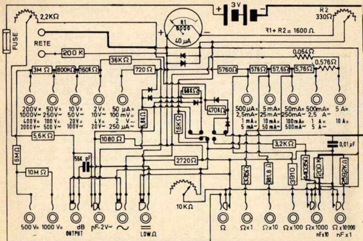
SCHEMA ELETTRICO DEL SUPERTESTER 680/R I.C.E. - 5<sup>a</sup> serie
