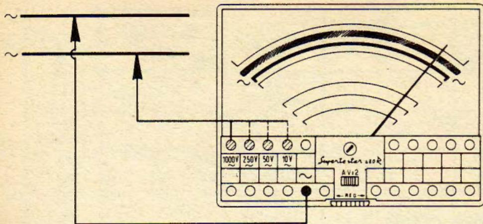
Schema come inserire il Supertester 680 R per le misure Voltmetriche in Corrente Alternata
