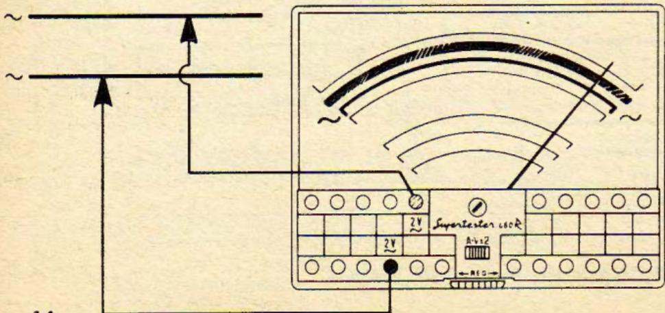
Schema come inserire il Supertester 680 R per misurare 2 V-C.A.
