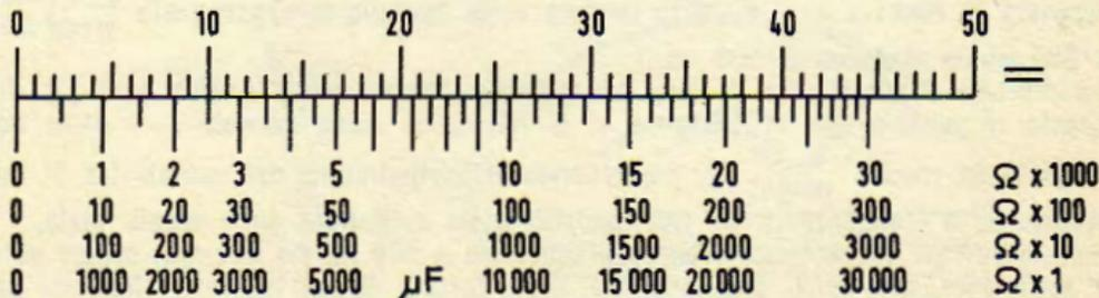
**Pettine di raffronto tra la scala 0 ÷ 50 e i diversi valori di capacità a seconda delle diverse portate ohmmetriche impiegate.**
