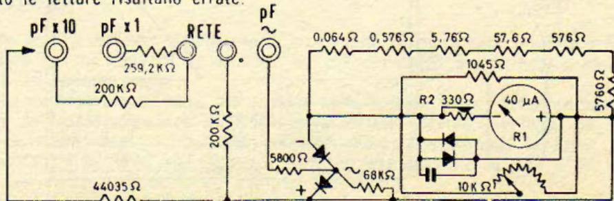
Schema semplificato misuratore di capacità
