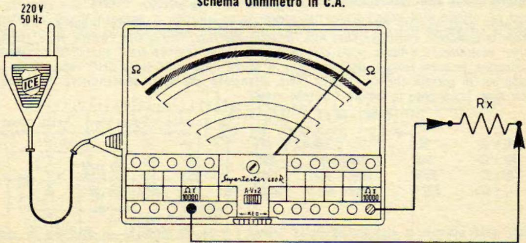
Schema come misurare resistenze di alto valore per mezzo presa di rete in C.A.
