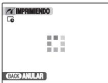
Pulse DISP/BACK para cancelar la impresión. En función de la impresora, es posible que no pueda cancelarse la impresión de forma inmediata o que ésta se detenga a mitad de impresión. Si la impresión se interrumpe en medio de la tarea, desconecte la cámara durante un breve espacio de tiempo y vuélvala a conectar.
