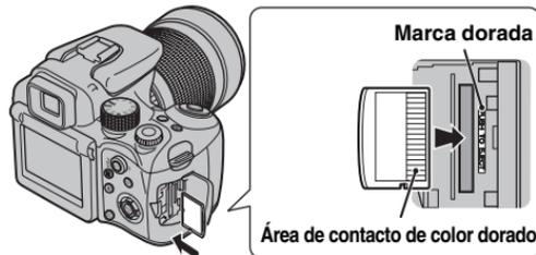
Alinee la marca dorada con el área de contacto de color dorado y, a continuación, inserte completamente una tarjeta **xD-Picture Card**.
