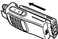
Fare scivolare la batteria sul retro del ricetrasmittitore fino a quando il blocco posto alla base della radio si aggancia e blocca la batteria.
