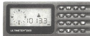
Di ogni sensore vengono memorizzate le letture massime e minime del giorno, del giorno precedente e dall'ultimo azzeramento. Per ogni sensore si possono inoltre impostare allarmi di massima e minima con avviso sonoro e visivo, per controllare che il vento non sia pericoloso per il parco antenne o per la barca ormeggiata in porto. Le nuove stazioni hanno quattro esclusivi sistemi di comunicazione seriale RS-232, per collegamento a PC, a modem telefonico o a TNC packet radio.
