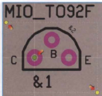
figura 5 Punti di selezione (in giallo) e punto di riferimento (in verde) del blocco
