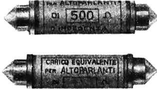
FIG. 18. - Capsule di carico equivalente.
