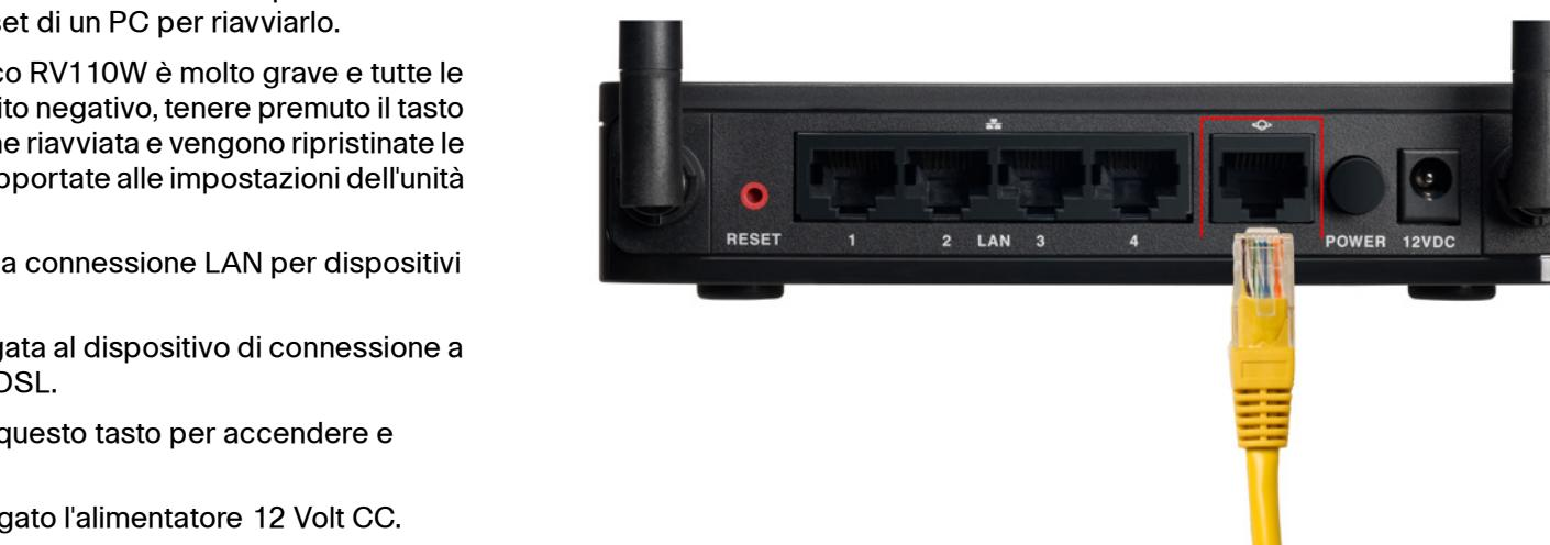
**PASSAGGIO 3** Collegare un'estremità di un altro cavo Ethernet a una delle porte LAN (Ethernet) sul retro dell'unità (in questo esempio viene utilizzata la porta LAN1). Collegare l'altra estremità a una porta Ethernet del PC che verrà utilizzato per eseguire la procedura di installazione guidata e Device Manager, entrambi basati sul Web.
