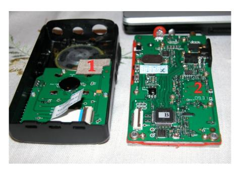
Rimuoviamo il pad di protezione adesivo vicino all'altoparlante, sotto troveremo la capacità di blocco del mic in smd da rimuovere.
