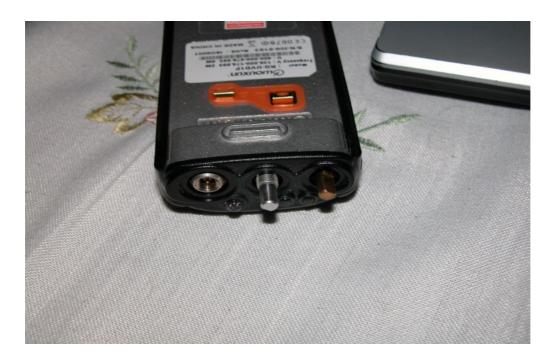
Per separare il corpo metallico della radio dal semiguscio in plastica è sufficiente fare leva sul fondo del corpo metallico con un cacciavite philips piatto in modo da portare in fuori il sudetto. IMPORTANTE : non separare le 2 parti di scatto e con forza in quando vi è una FLAT all'interno che potrebbe danneggiarsi, bisogna procedere con calma e una volta che la flat è accessibile, scollegarla, quindi terminare la separazione.
