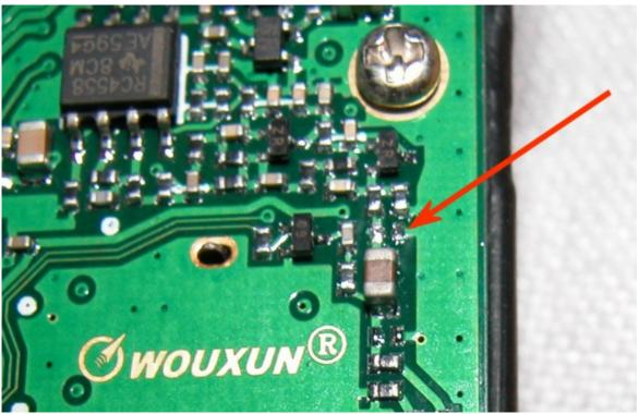
2° capacità di blocco del mic da rimuovere Quest'ultima capacità puo' essere lasciata nel caso non vogliate alterare il comportamento di eventuali mic esterni.....
