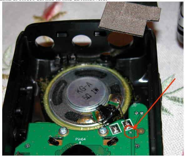
Per rimuoverlo è sufficiente toccare i 2 lati del componente con la punta del saldatore tenuta parallela al componente stesso in modo da fornire calore ad entrambi i "reofori" (anche se non si puo' parlare di reoforo per un'smd) quindi imprimere o con la punta stessa o con un altro utensile una spinta perpendicolare al fianco del componente in modo da favorirne il distacco.
