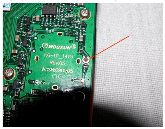
La regolazione puo' essere fatta ad orecchio utilizzando una altro apparato in Isofrequenza oppure mediante TestSet. Per incrementare la deviazione è sufficiente ruotare in senso antiorario il trimmer. Personalmente l'ho regolato ad orecchio facendogli compiere un giro di 180° antiorario e il risultato è stata una modulazione squillante e meno cupa rispetto all'originale. Mi riservo ovviamente appena possibile di dargli una misurata con il test set di laboratorio.
