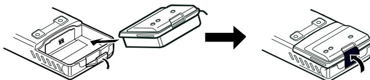
Se la batteria non è mai stata usata o se è completamente scarica, provvedete a caricarla collegando, come mostrato in figura, per due ore l'adattatore di rete **NC-72C/U** al connettore d'alimentazione esterna **EXT DC**. Se disponete solo di una tensione continua da 12 a 16 V potete usare l'adattatore opzionale l'**E-DC-5B** o l'**E-DC-6** (quello con la spina tipo accendisigari per auto), vedi figura.
