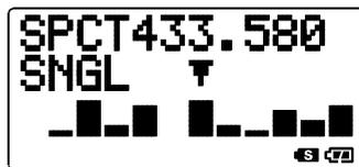
Per disattivare l'analizzatore di spettro e passare ad operare sulla frequenza centrale dello schermo premere **PTT**, **[F/W]** e **LAMP**.
