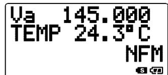
Sullo schermo al posto dell’indicazione di frequenza del VFO secondario appare la misura della temperatura all’interno del **VX-5R**.
