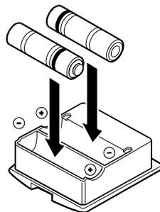
L’**FBA-23** non dispone dei contatti per la carica in quanto le pile alcaline non possono essere ricaricate. Invece è comunque possibile connettere l’**NC-72C/U**, **E-DC-5B** o l’**E-DC-6** al connettore per l’alimentazione esterna **EXT DC**.
