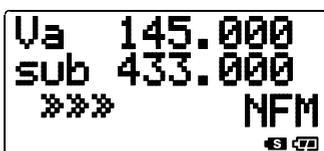
Se l'impostazione corrente visualizza la frequenza a caratteri piccoli (a singolo o doppio VFO), mantenete premuto per un secondo il tasto **[4(MG)DSP]** per passare indicazione di frequenza del solo VFO principale a caratteri grandi, premendo ancora per un secondo lo stesso tasto si ritorna al modo "caratteri piccoli" a uno o due VFO, dipende da come impostato nel paragrafo precedente.
