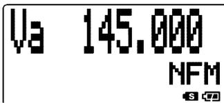
Se l'impostazione corrente visualizza la frequenza a caratteri grandi (riferirsi al disegno), mantenete premuto per un secondo il tasto **[1(TN)FRQ]** per passare alla doppia indicazione di frequenza per entrambi i VFO, premendo ancora per un secondo lo stesso tasto scompare l'indicazione di frequenza del VFO secondario.
