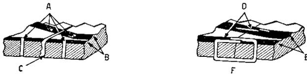
Fig. 24.5. - Riparazione di un pannello fratturato.
