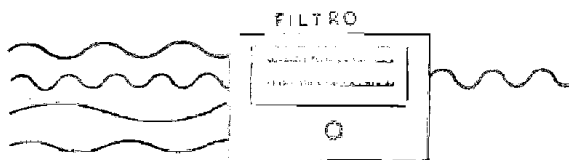
Fig. 2.2. - Un filtro è posto all'entrata di qualsiasi apparecchio radio. Ad esso giungono molte onde radio, ma ne lascia passare una sola.
