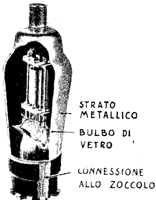
Fig. 5.8. - Lo strato metallico esterno di cui sono provviste alcune valvole moderne costituisce uno schermo di protezione contro azioni elettriche esterne. Le quattro prime valvole di fig. 5.10 sono di questo tipo.
