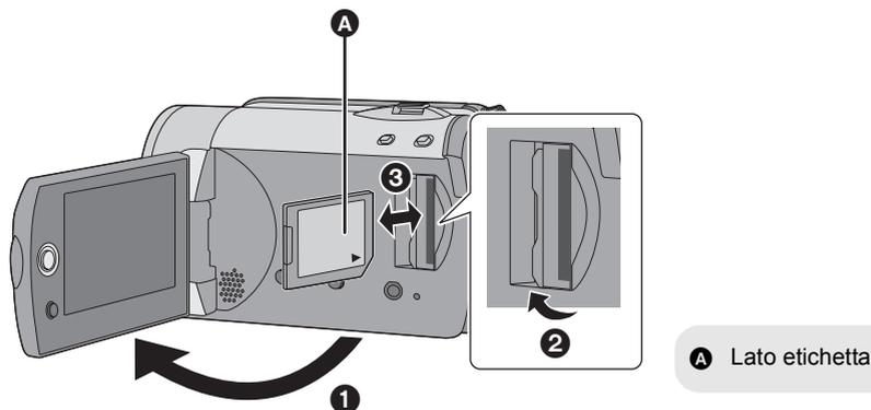
**1 Ruotare il selettore della modalità di funzionamento su OFF.**
