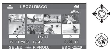
**4** Selezionate l'operazione di riproduzione con il joystick.
