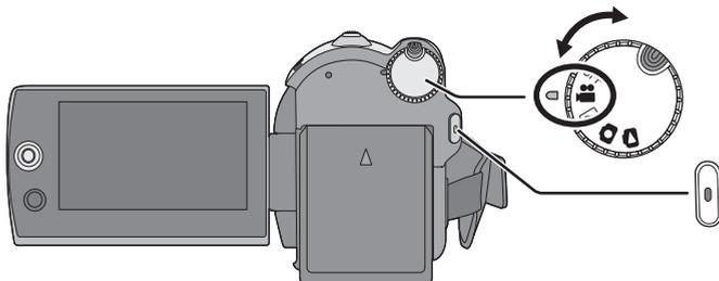
**1** Ruotate il selettore della modalità di funzionamento per selezionare e aprite il monitor LCD.
