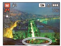
Valore apertura/velocità otturatore
