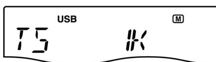
3. Tramite il [DIAL] selezionare l'incremento richiesto fra 0.1, 1, 5, 9, 10 kHz.
