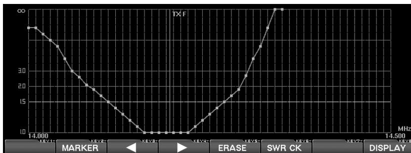
Per poter misurare correttamente l'SWR di un sistema d'antenna dovete per prima cosa disattivare l'accordatore.
