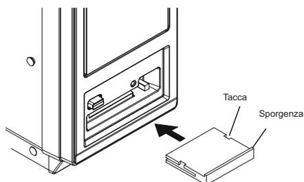
Per rimuovere la scheda dalla sede premete il piccolo tasto d'estrazione nel lato destro della sede. Avvertenza: se appare il messaggio d'errore "CF CARD NOT READY" sul monitor commerciale, verificate l'orientazione scheda.
