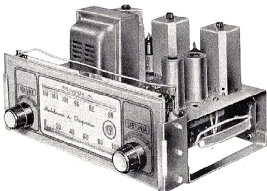
Consente la ricezione e la riproduzione delle trasmissioni modulate in frequenza usando qualsiasi amplificatore di buona o alta fedeltà. È indicato particolarmente per la realizzazione di complessi di Alta Fedeltà a BF.
