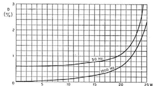
Curve della distorsione in funzione della potenza.
