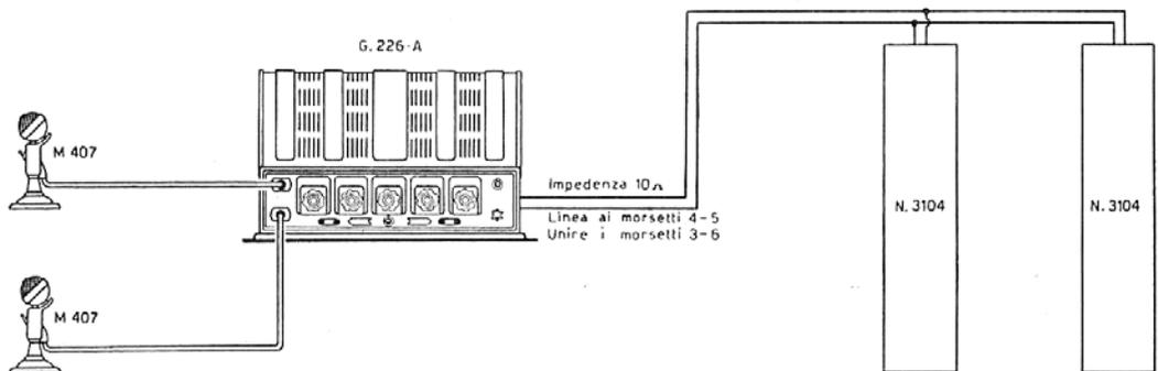
In questo esempio due altoparlanti Cat. N. 3104 sono collegati in parallelo tra loro: l'impedenza risultante di linea è di 10 ohm. La potenza massima applicabile a ciascuno, considerato che qui è utilizzato un amplificatore G 226-A, è di circa 12 watt.
