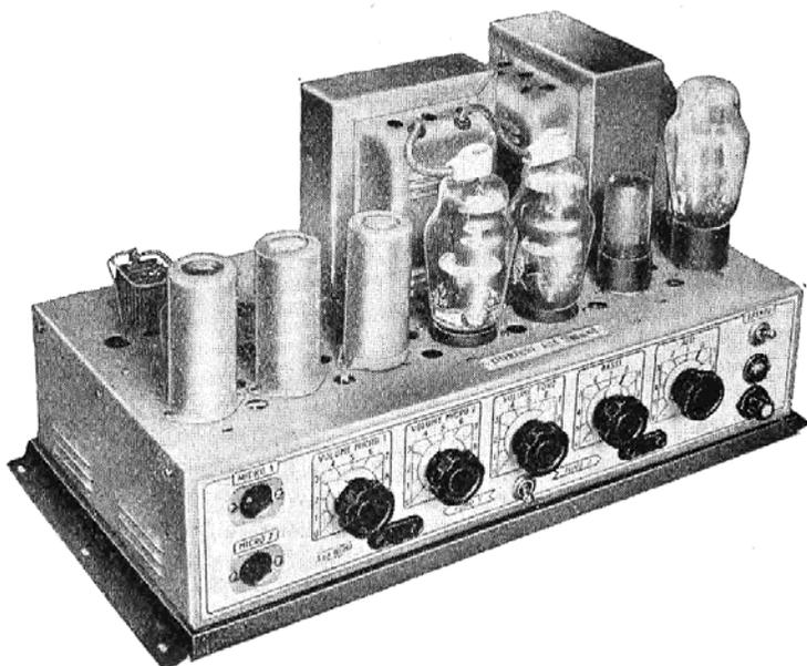
Amplificatore G 260-A visto senza la gabbia superiore di protezione. Sono chiaramente visibili anche i collegamenti alle placche delle valvole finali, uscenti direttamente dalla calotta del trasformatore d'uscita.
