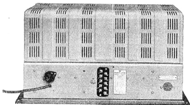
Parte posteriore del G 260-A. Da sinistra a destra: cambio tensioni, morsetto per il collegamento a terra, morsettiera di uscita e tabella delle combinazioni di impedenza, attacco per l'alimentazione anodica dell'adattatore di cellula fotoelettrica.
