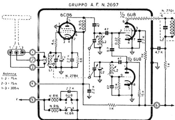
Nel progetto di un efficiente Gruppo RF per la Modulazione di Frequenza è necessario tenere presenti tre elementi di fondamentale importanza: la sensibilità, la stabilità, il rumore di fondo.
