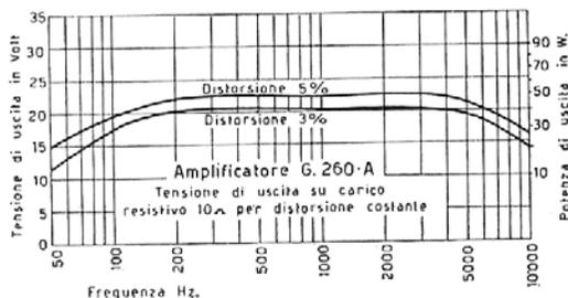
Curve della tensione e potenza d'uscita al 5 ed al 3 per cento di distorsione.
