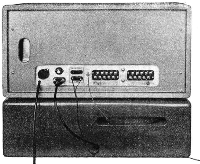
Vista posteriore dei centralini G 1510-C e G 1520-C. Da sinistra a destra, nell'ordine: cavo di collegamento con la rete di alimentazione c.a.; cambio tensioni; fusibile; presa di tensione per l'alimentazione di un giradischi o di un magnetofono; presa per il collegamento con l'entrata di un magnetofono (per la registrazione); presa per fono; cavetto d'antenna; morsettiera di uscita con i morsetti numerati; morsetti di massa (avvitati direttamente nel telaio).
