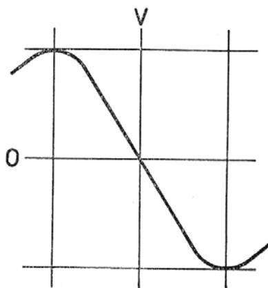
Curva caratteristica del rivelatore a rapporto, vista all'oscilloscopio e ottenuta con un segnale vobbulato almeno  $\pm 100$  kHz.
