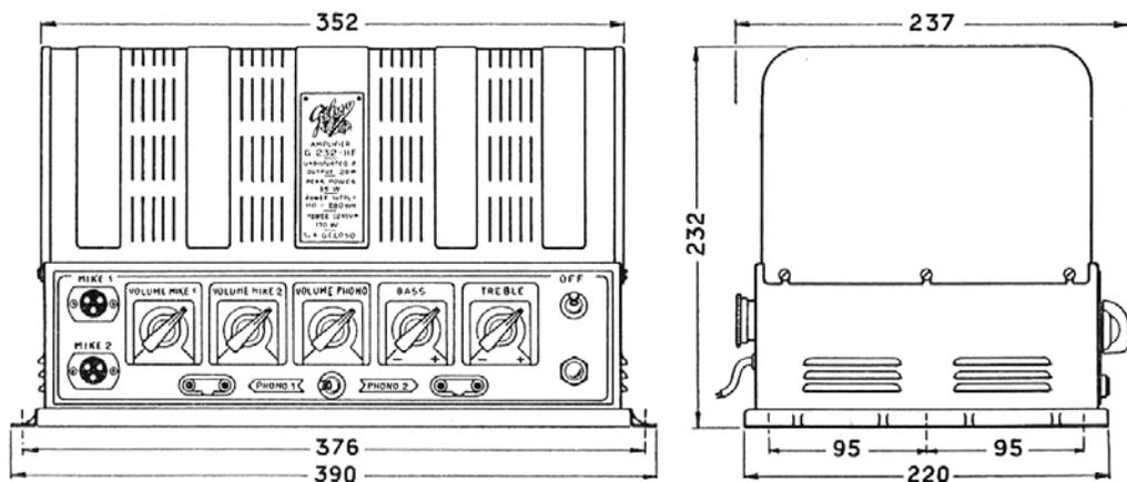
Dimensioni d'ingombro e distanza tra i fori di fissaggio del G 232-HF.
