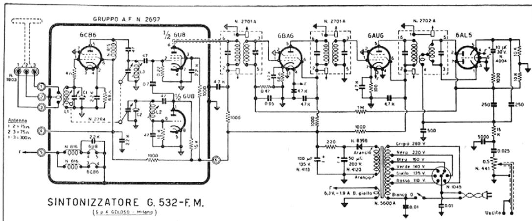
L'accoppiamento tra le valvole di FI è effettuato con trasformatori a primario e secondario accordati mediante nuclei ferromagnetici spostabili.
