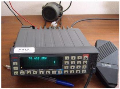
Si tratta di un ricetrasmettitore civile che si può trovare nelle versioni VHF LOW, VHF e UHF e si presta molto bene ad essere convertito per l'uso in gamma radioamatoriale compresa la nuova gamma dei 70MHz con il firmware di PA4DEN (rats v3).
