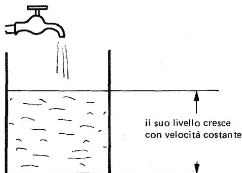
La velocità di salita del livello dipende dall'erogazione del rubinetto e dalla capacità del serbatoio
